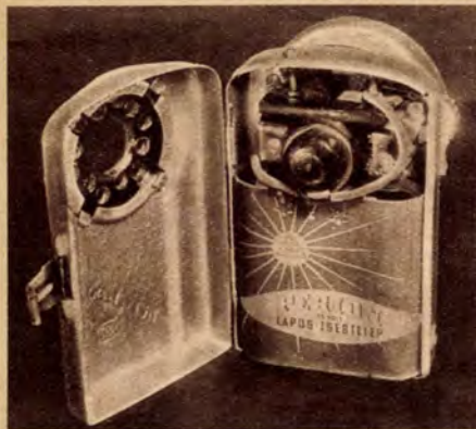
A beépített motor az érintkezőkkel. Balra A „védőráccsal” ellátott kész ventilátor láthatjuk a levegőnyílásokat
