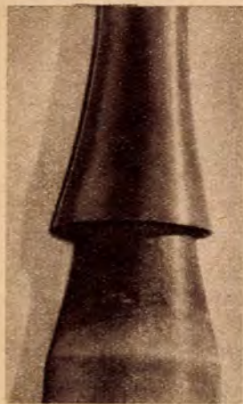
PVC csődarab alakítása formázóján
